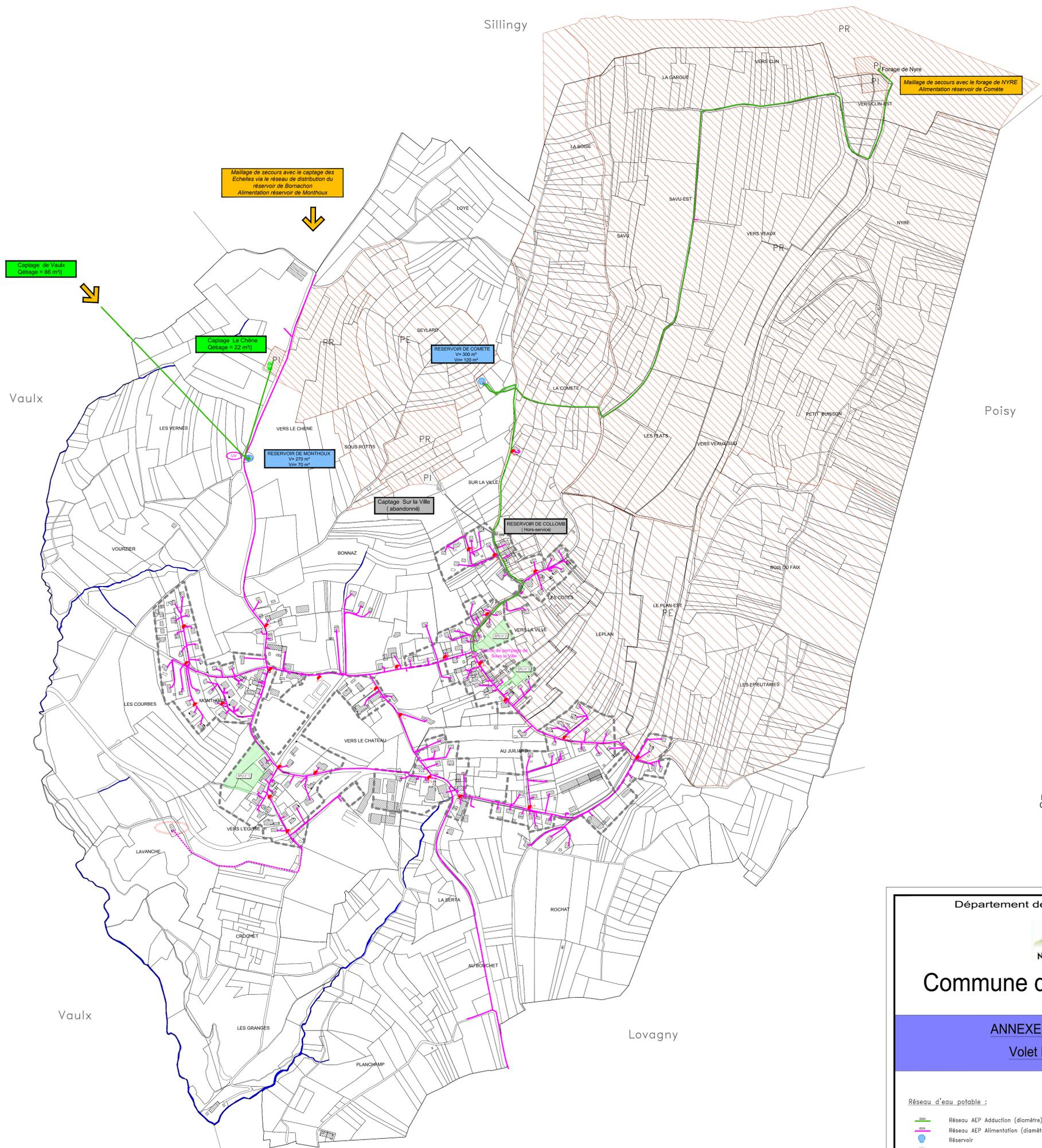
Maillage de secours avec le captage des Echelles via le réseau de distribution du réservoir de Bomachon
